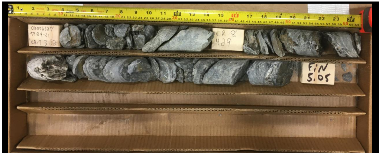
Photographie #9 : TF-24-21 – 3,32 à 5,05 mètres.
